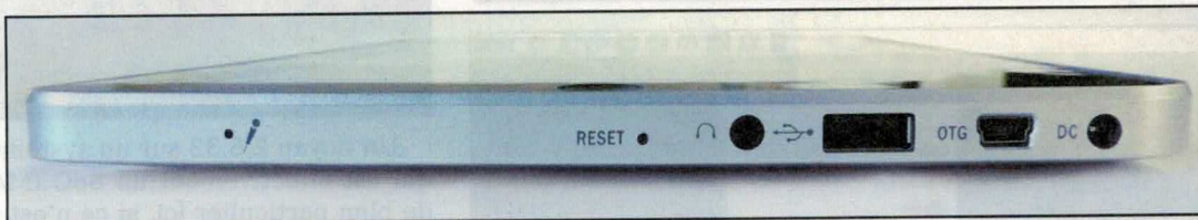
L'aPad est riche en possibilités de connexion, contrairement à la tablette dont le design a été copié. De gauche à droite, micro, bouton de reset (trombone obligatoire), sortie audio, port USB hôte, USB OTG (ADB) et connecteur d'alimentation. Non visible sur la photo, l'aPad dispose également d'une connectique Ethernet et d'un slot pour carte micro-SDHC.
