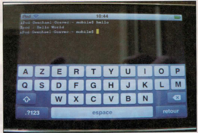
Figure 1 : Exécution d'une application POSIX dans le MobileTerminal de l'iPod Touch, application compilée au moyen de la toolchain mise en place sur plate-forme x86.
