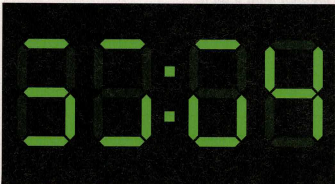
Figure 7 : Cet afficheur est complet, mais les segments sont contrôlés pseudo aléatoirement.
